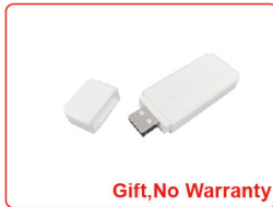
投影幕升降無線觸發器(贈品) 插在投影機USB接口，待投影機開關電源時，自動觸發投影幕的升降。
