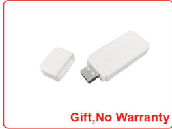
投影幕升降無線觸發器(贈品) 插在投影機USB接口，待投影機開關電源時，自動觸發投影幕的升降。
